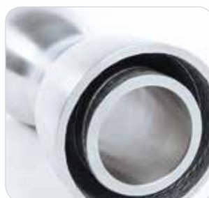
Tenkostěnný díl - finální dokončení
